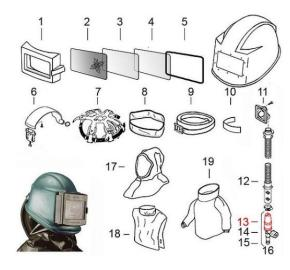
Regelkran incl. Schalldämpfer und CEJN Anschluss für Sandstrahlhelm
