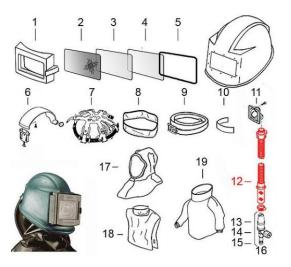
CEJN Anschluss mit 1/4 Innengewinde für Sandstrahlhelm
